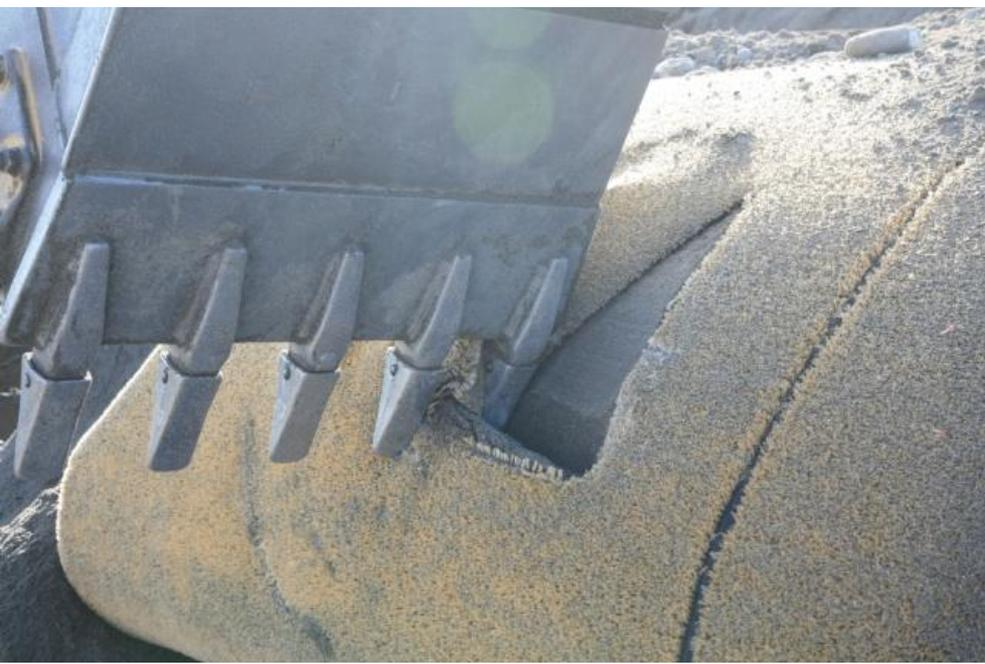
掘削機バケットによる引裂き
