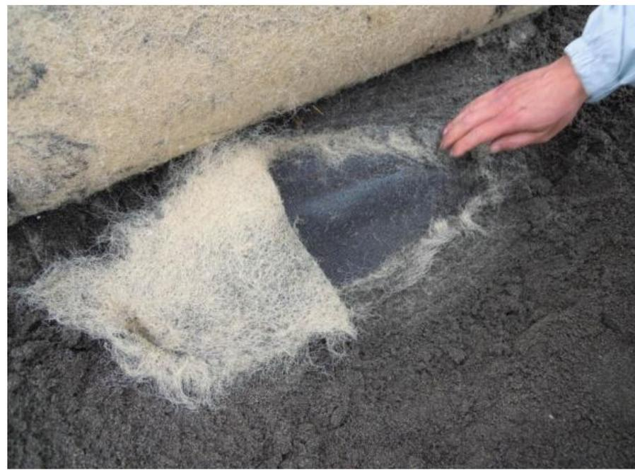
カタピラ等旋回時の破損
