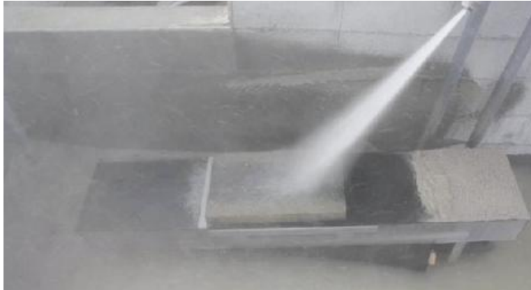
コンクリート供試体の摩耗試験
