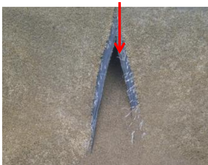
変形に伴う張力増加によって考えられる縫製部の損傷例
