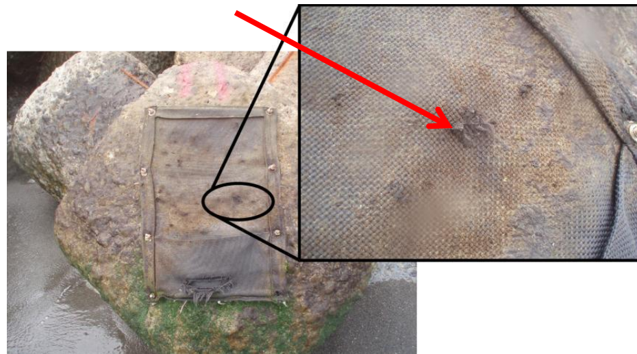
磨耗促進試験で見られた袋材の損傷例
