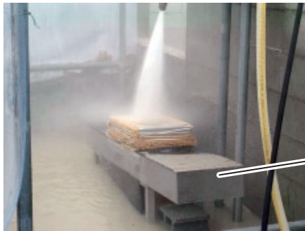
耐摩耗性試験の状況
